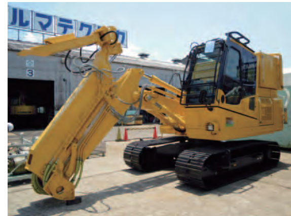
船内棚落し機 船内の突起物などに引っ掛かったマテリアルを効率良く船底へ落とすための仕様車です。
