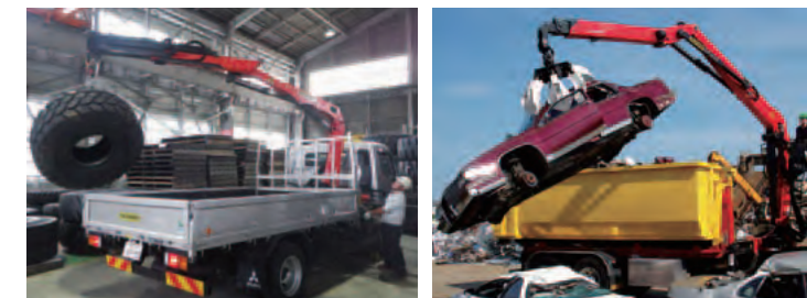
パルフィンガークレーン／エプシロンクレーン トラック積載型の屈曲式ローダークレーンはブーム先端にあるフックで直接荷を吊り上げる構造により、荷を素早く移動させられるという特長があります。また、フックの代わりにグラブを付け、木材や金属スクラップをハンドリングする専用機としても広く利用されています。
