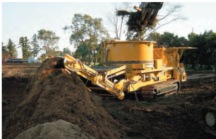
自走式タブグラインダー 木材や巨木根等を効率的・安全に均一チップ化します。
