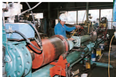
油圧シリンダーの再生 高トルクのシリンダーリベアスタンドを用いて、大型シリンダーのオーバーホールを実施します。また整備後は豊富なテスト機器を使用して万全を期します。
