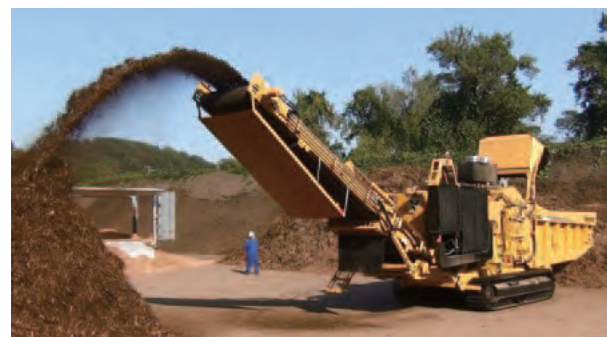
自走式水平グラインダー 破碎ドラムを載せ替えることにより、丸太を破碎して切削チップ化した燃料用チップの生産と選定枝葉・根株などを破碎してピンチップ化した堆肥・畜産敷床材の生産を可能にしました。
