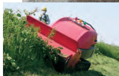
有人無人対応型ハンドガイド草刈機 特定小電力無線局を搭載し、遠隔操縦でも搭乗でも操作可能な草刈機です。
