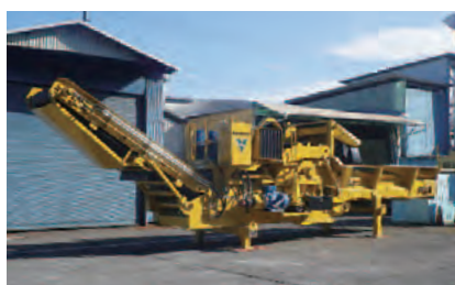
電動式水平グラインダー 環境アセスの騒音・振動・粉塵などを抑え、ランニングコストの低減を図っています。また、破碎ドラムを載せ替えることにより、切削チップとピンチップの生産を可能にしました。
