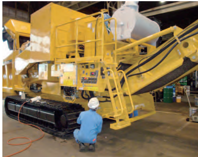
木質系破砕機の整備 稼働時間に応じて入念に整備を行います。お客様の立場に立って安全対策、強化対策も実施します。
