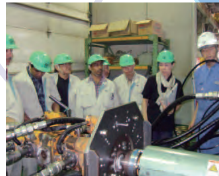
油圧テスターによる性能試験
