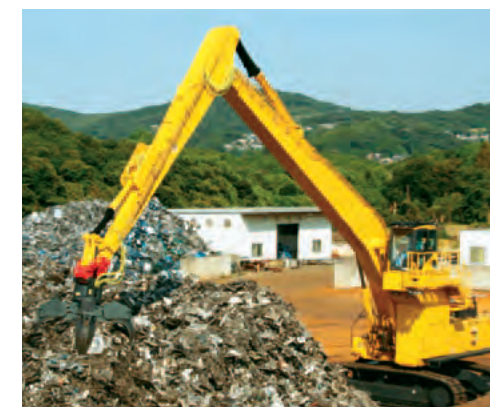
マテリアルハンドリング仕様車 ロングブーム・アームの先にグラブバケットを装備。スクラップの積込み・荷降し、狭いスペースの高積み等に能力を発揮します。
