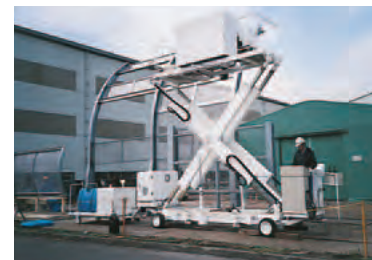
道路遮音壁清掃機 省力化機械設計タイプの高速道路遮音壁清掃機です。
