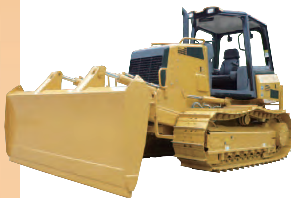
ツーウェイドーザー 狭い船倉内で搬入(かき集め)・搬出(押し出し)作業を効率よく行えます。
