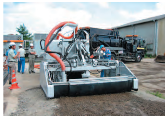
廃材回収機 橋梁等のコンクリートをウォータージェット(超高压水流)で中の鉄筋を傷つけずに破碎し回収します。
