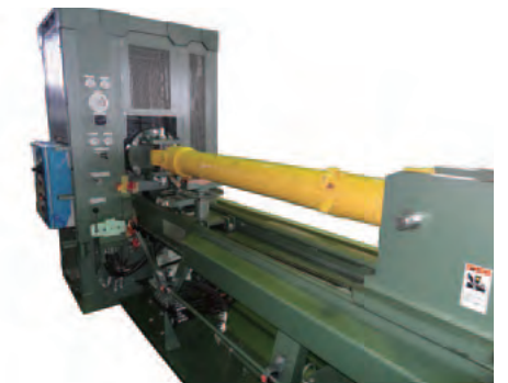
シリンダリペアスタンド 大型油圧シリンダの分解・組立・オイル漏れ検査をこのスタンド一台で行えます。締付トルク管理も行えます。
