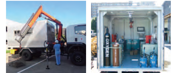
工作車 修理設備を搭載した車両です。特に海外の工事現場ではワゴン車から大型車まで修理目的に応じた工作車や給油車が活躍しています。
