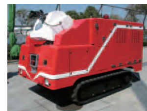
無人走行放水車 特定小電力無線局を搭載し、100mから300mくらいの遠隔操縦が可能な放水車です。
