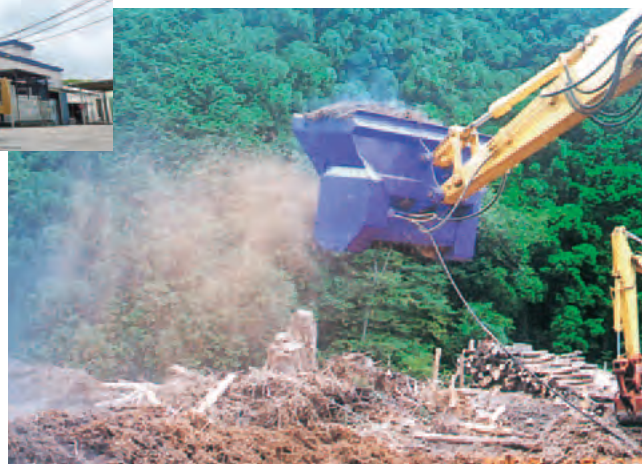
チップ散布機 チップをマルチング材として吹き付ける作業や、ゴルフ場の目砂散布、果樹園や農園の堆肥の散布・切り返し等が効率良く行えます。
