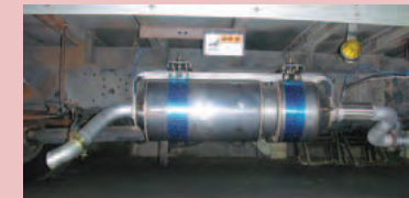
「スモークバスターNシリーズ」 国土交通省の認定を受けた自動車NOx・PM法対応装置。自動車NOx・PM法に適合しないため、車検の継続ができない車両を、本装置を装着することにより車検を可能にする装置です。
