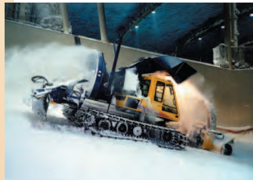
雪再生機 スキー場等のアイスバーンを削り取り新雪のように再生して散布します。
