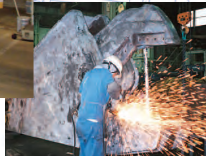
解体用アタッチメントのツール加修風景 長年培ってきた溶接技術によって、さまざまな消耗部品の肉盛再生を行います。
