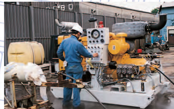
オーバーホール後のウォータージェット装置負荷試験 超高压ウォータージェットが国内に導入された当初からの長い整備経験を持ち、安全性も配慮した確実なメンテナンスサービスを実施します。
