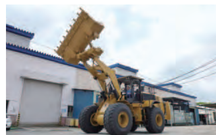
サイドダンプバケット 前方向だけでなく、左右両側へも排土できることで、旋回が困難なトンネル工事などで使用されます。
