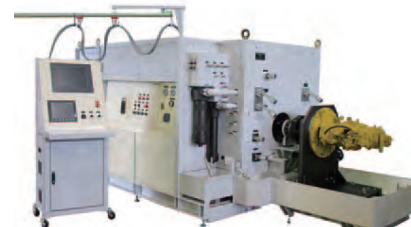
再生型油圧試験機 油圧ポンプ・モーターの性能確認試験機で作業性に優れ、再生回路により消費電力を削減できます。
